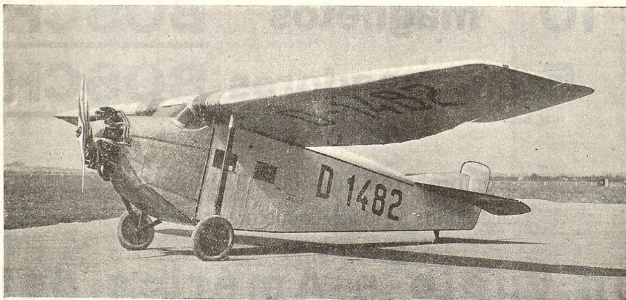
Avión de viaje económico «Focke- Wulf» A20, con motor radial de 240 CV. (avión pequeño para trabajos aerofotográficos)
