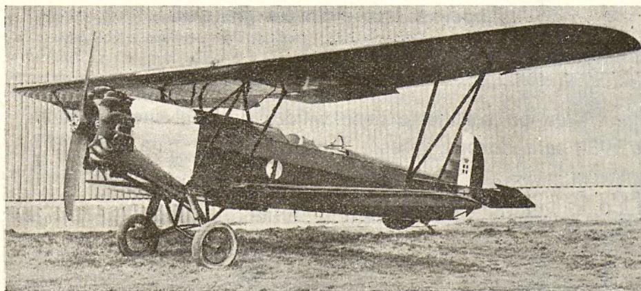
Ro. 1, con tren de aterrizaje oleoelástico.
