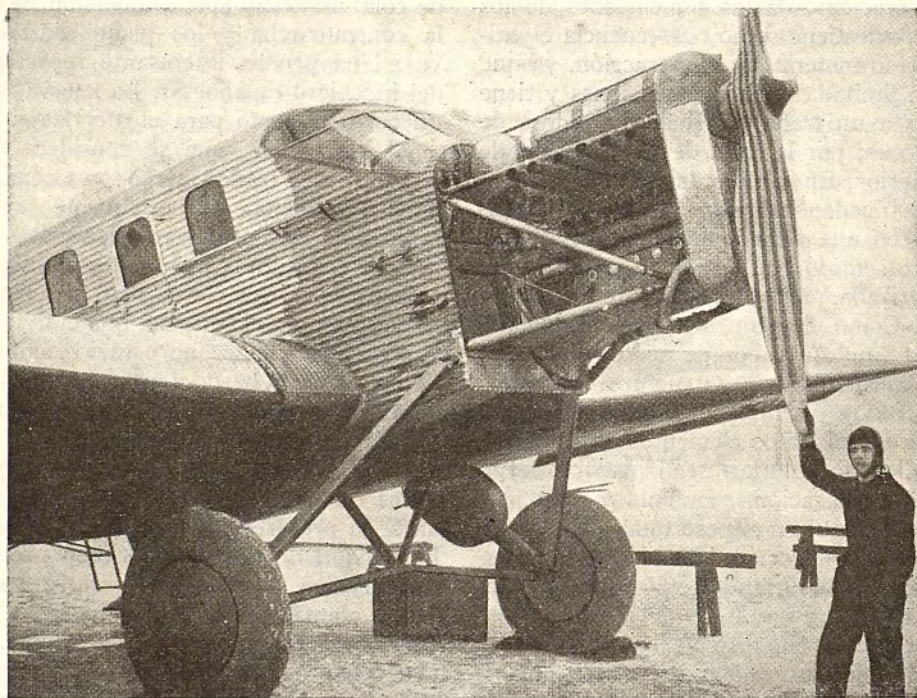
Un motor Diesel de 600/700 CV., peso 800 kilogramos, que ha efectuado su primer vuelo, con éxito, el 4 de febrero de 1929
