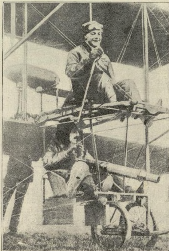
Aeroplano británico con un cañoncito y el aparato de lanzar bombas
