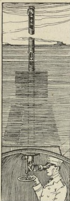
El periscopio de un submarino. Obsérvese el juego de las lentes y cómo el oficial puede hacer girar el objetivo para explorar el horizonte en todos sentidos.
