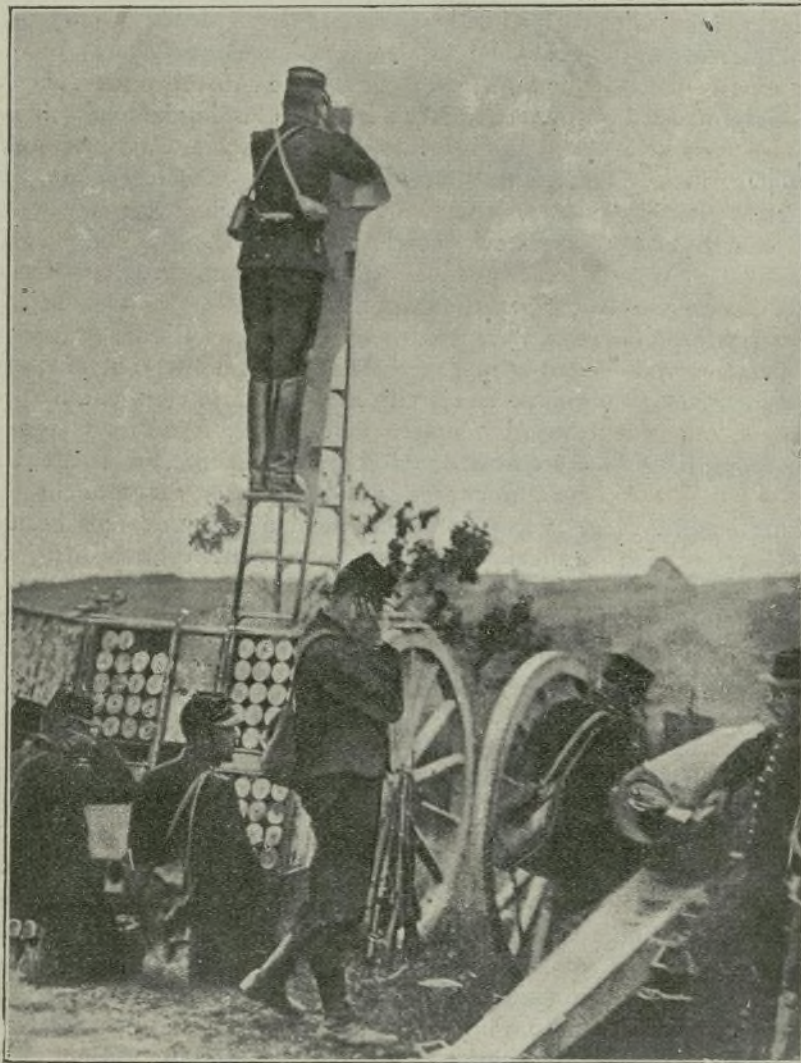
Cañón francés de campaña en posición de fuego, con la escala-observatorio
