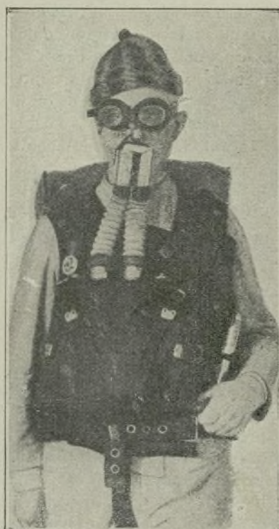
El «Salvador» Dräger, aparato de salvamento de que van provistas las tripulaciones de los submarinos alemanes, para caso de siniestro
