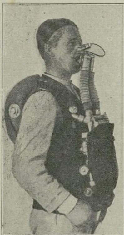
El «Salvador» Dräger, aparato de salvamento de que van provistas las tripulaciones de los submarinos alemanes, para caso de siniestro
