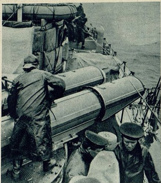
La marine britannique en guerre : (1) Pointage d'un double tube lance-torpilles ; (2) La torpille sortant du tube.
