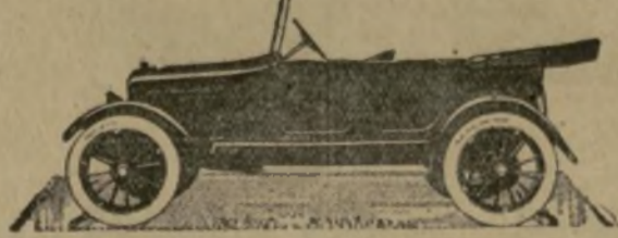
Longueur de suspension 3 m. 30. Empattement 2 m. 54.
