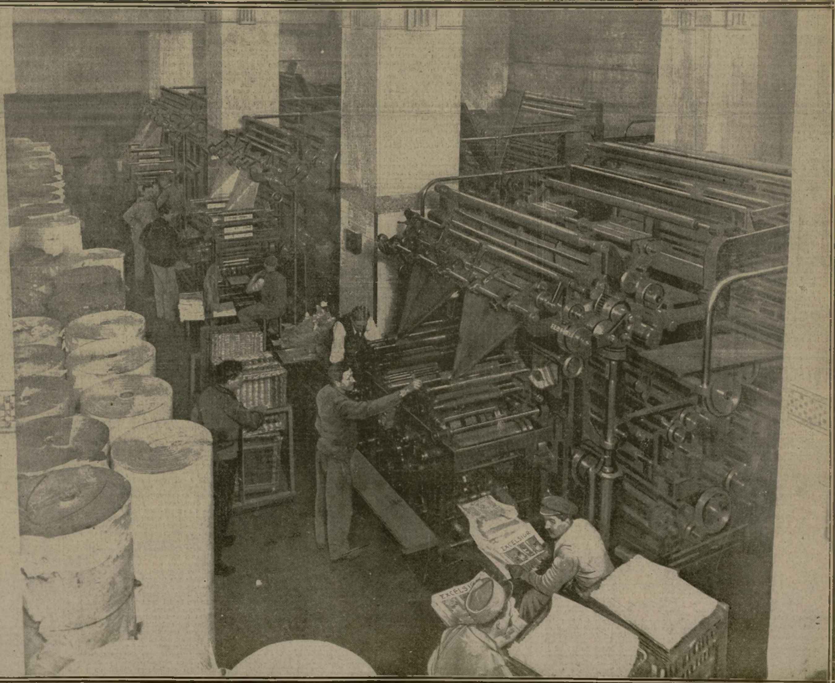
LES ROTATIVES A GRANDE VITESSE QUI IMPRIMENT “EXCELSIOR”. — VUE D'ENSEMBLE DE LA SALLE PENDANT LE TIRAGE
