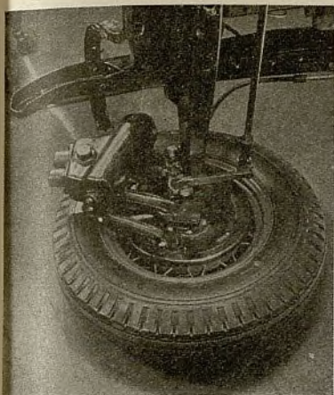
Suspensión delantera del Pontiac. Se diferencia de la de los otros automóviles de la General Motors, en que es del tipo de brazo acodillado.
