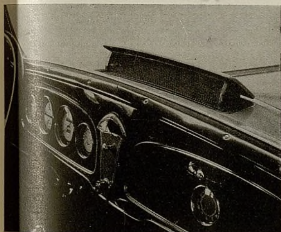
La ventilación por el cubretablero del nuevo Buick se abre hacia atrás, recibiendo la corriente de aire que baja por el parabrisa.
