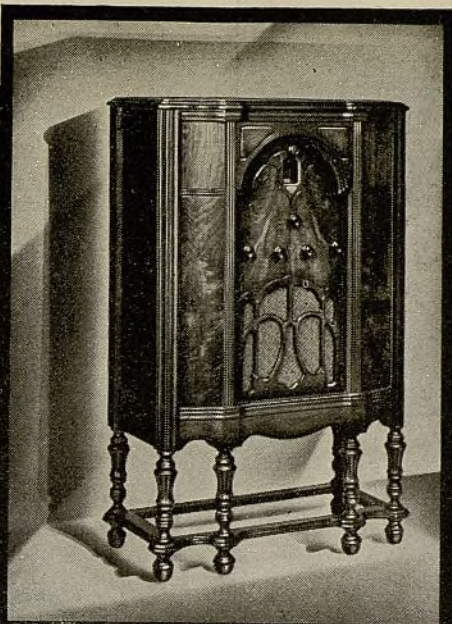
MODELO 261 —magnífico superheterodino Bi-Acoustico de diez tubos. Está provisto de doble control automático de volumen, altoparlante de 25 cm. (dinámico), chasis suspendido sobre cojinetes de caucho, control compensador de volumen.
