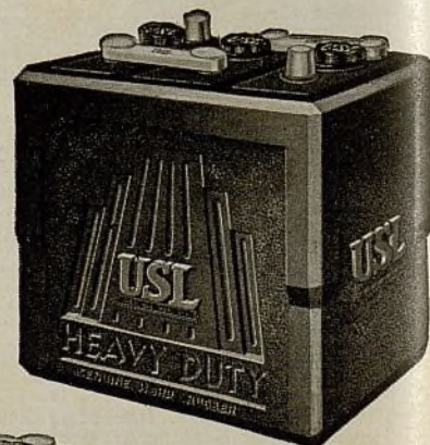
Acumulador USL "Heavy Duty" Diseñado especialmente para camiones. Elementos de tamaño normal y nuevo Óxido USL—Separadores protegidos con vulcanita. Caja de vulcanita.
