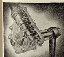
Mecanismo de Dirección. Tipo de leva y palanca, empleado en el 80% de los camiones. Reconocido como el más dócil, siendo fácil de ajustar y de larga duración.
