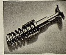
Amortiguador de Resorte de Válvula. Las válvulas de admisión y de escape van provistas de amortiguador que impide la trepidación de los resortes.
