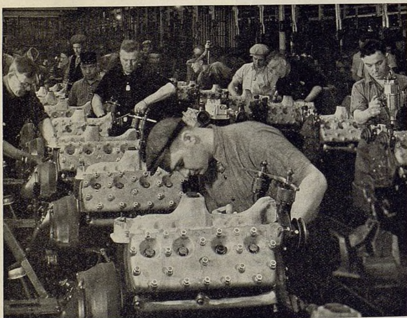
Inspección de bloque de cilindros de Ford y (abajo) verificación final en la línea de montaje de modelos V-8.
