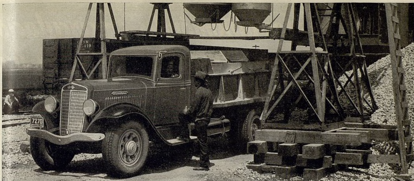
Este grande y poderoso camión es el nuevo International, modelo C-55, provisto de garita o compartimiento de conductor cerrado y carrocería de vuelco.
