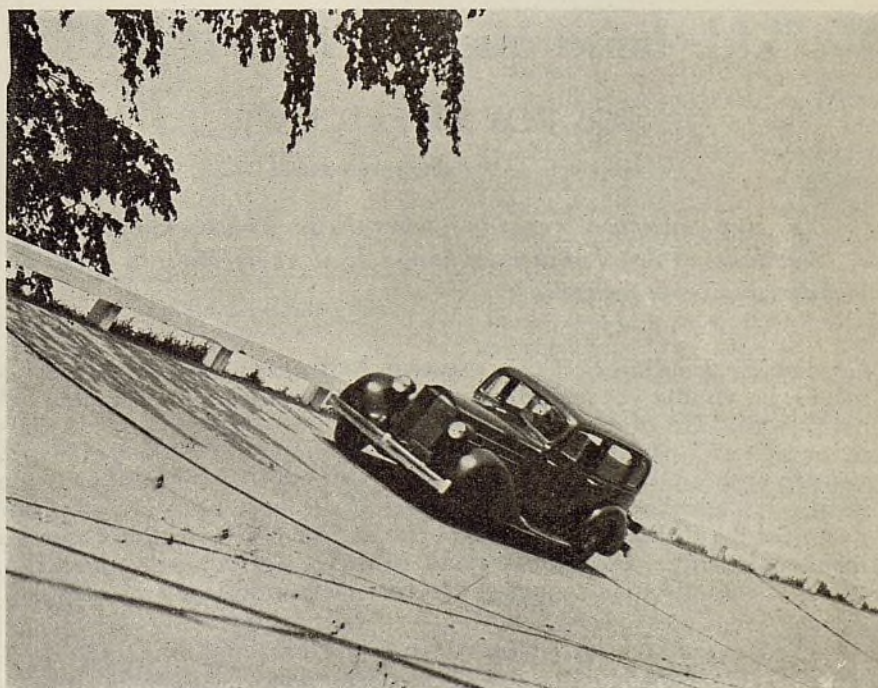
Corriendo día y noche en una pista de carrera de hormigón de 2\frac{1}{4} millas de circunferencia, en el campo de prueba de la Packard, un Packard de estilo normal viajó 25.000 millas, es decir, 40.000 kilómetros, a todo escape, promediando 90 millas por hora (144 km.) para toda la distancia. El motor funcionó a una velocidad promedio de 4.000 r.p.m.
