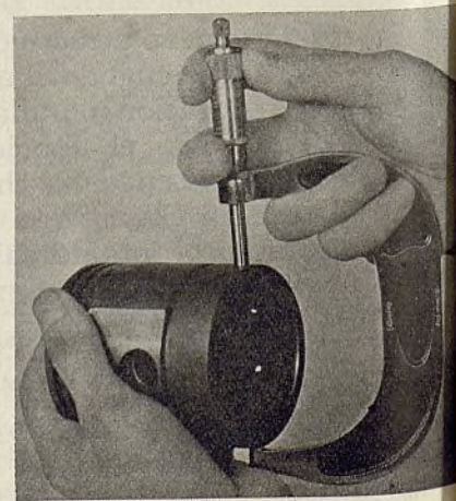
Fig. 8—Manera de medir el diámetro de un émbolo con la ayuda de un micrómetro.
