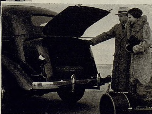
En los modelos Plymouth provistos de baúles, el neumático de recambio queda completamente oculto.
