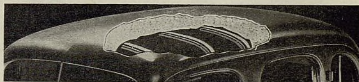
Techos metálicos se incluyen en muchos de los modelos de 1935. Mostramos aquí el techo metálico empleado en el Pontiac. Tómese nota de los arcos de acero y el aislamiento de fieltro de la acústica.
