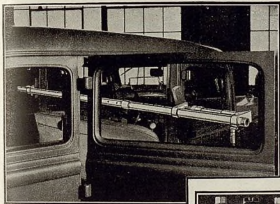
Sujeción—restableciendo la carrocería del automóvil a su forma primitiva después de su ensanchamiento por tensiones laterales o caída.
