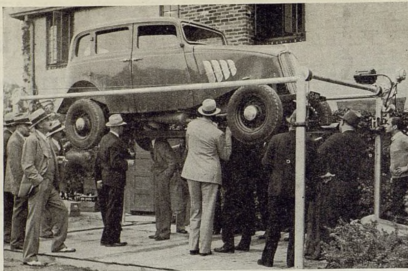
Modelo en ensayo con suspensión independiente en las cuatro ruedas
