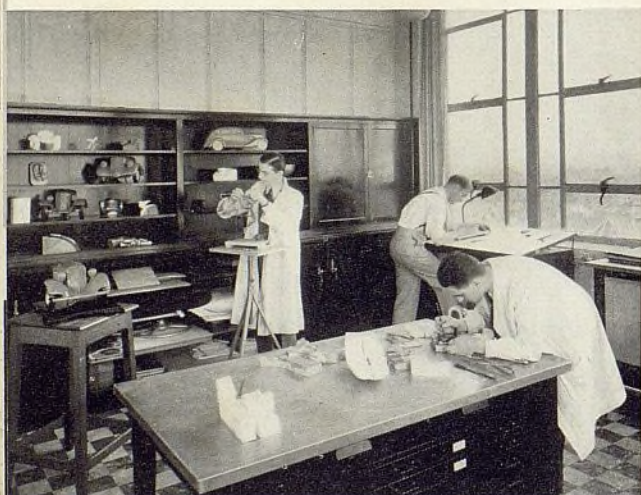
● (Izquierda) Un grupo de escultores modelando ornamentos para radiadores, guarniciones interiores y secciones exteriores de los automóviles en embrión.
