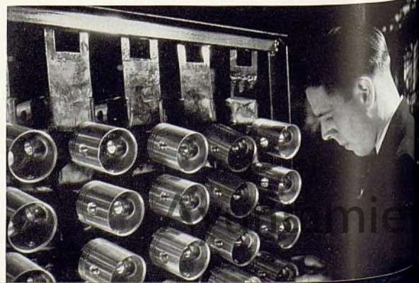
● (Derecha) Los émbolos se someten a un tratamiento electrolítico con el objeto de darles mayor dureza, larga duración y un funcionamiento irreprochable.
