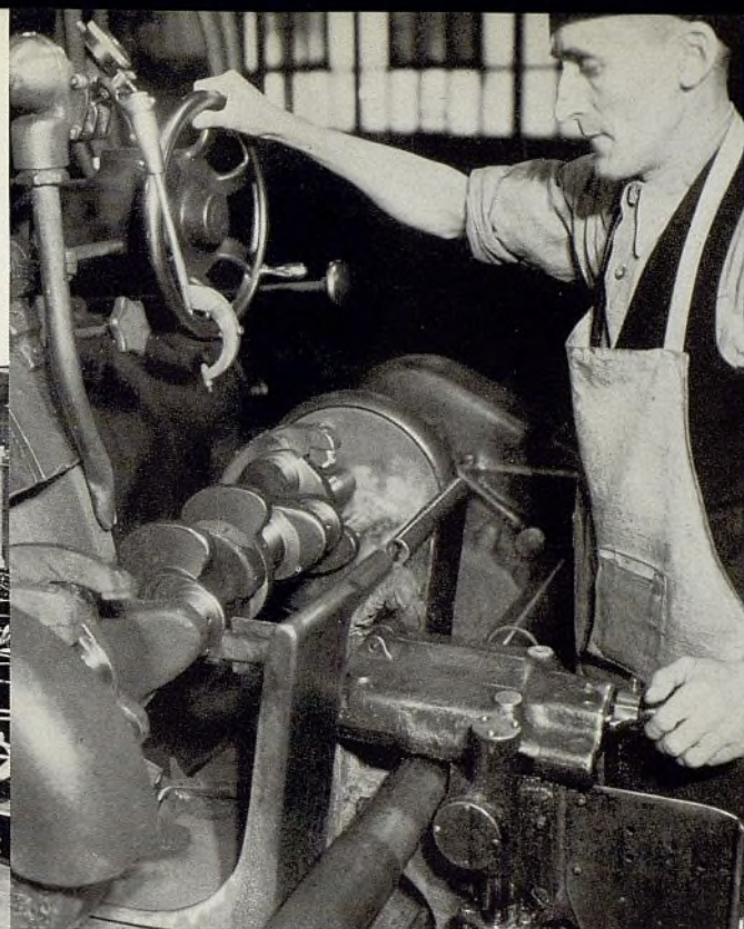
● (Derecha) Esmerilando el sólido cigüeñal contrapesado, para asegurar su equilibrio en movimiento y en reposo.
