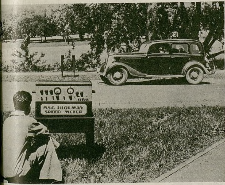
Abajo—Este medidor de velocidad es la última palabra en exactitud. El vehículo intercepta rayos de luz paralelos. La diferencia de tiempo en la intercepción queda indicada en el instrumento y corresponde con la velocidad registrada en el cuadrante correspondiente.
