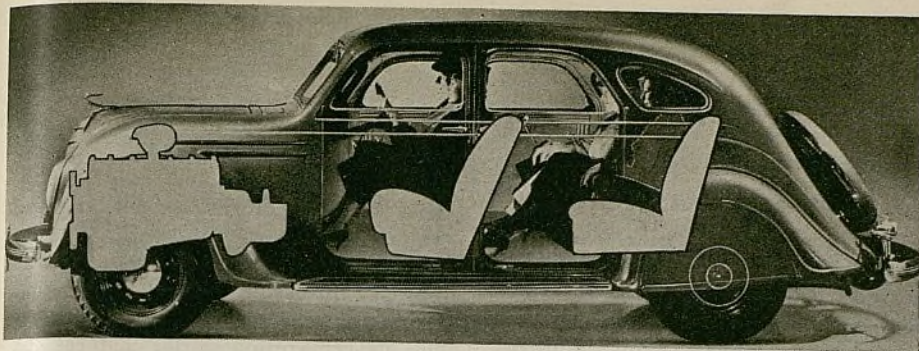
Fig. 1—Colocando el motor directamente encima del eje delantero, el DeSoto ha ganado espacio para el interior de la carrocería y ha hecho también posible reducir la amplitud del movimiento sentido en el asiento trasero
