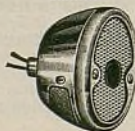
Lamparita de parada y señal trasera para el Ford
