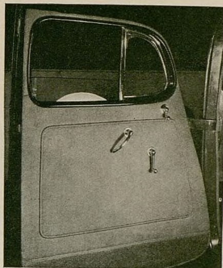
Izquierda—Tabique colocado encima y detrás de la bomba de combustible para activar la circulación del aire y evitar la contrapresión en la línea. Derecha—La bisagra superior es del nuevo tipo "oculto", que permite sujetar la puerta por su parte delantera, a pesar de la gran inclinación de esta sección. Cuando la puerta está cerrada, no se ve la bisagra
