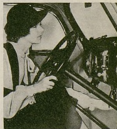
La palanca de enfrenamiento queda sin estorbar a la izquierda. Va montada en el tablero, lo que evita perforar la tabla de piso
