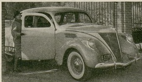
La parrilla del radiador del nuevo Lincoln tiene forma de V, con barras horizontales levemente curvas y con "ala voladora" arriba. Las lámparas están embutidas en los guardabarros. No hay chasis de construcción corriente, sino que la armazón reforzada de la carrocería sirve de soporte al motor y demás órganos del vehículo
