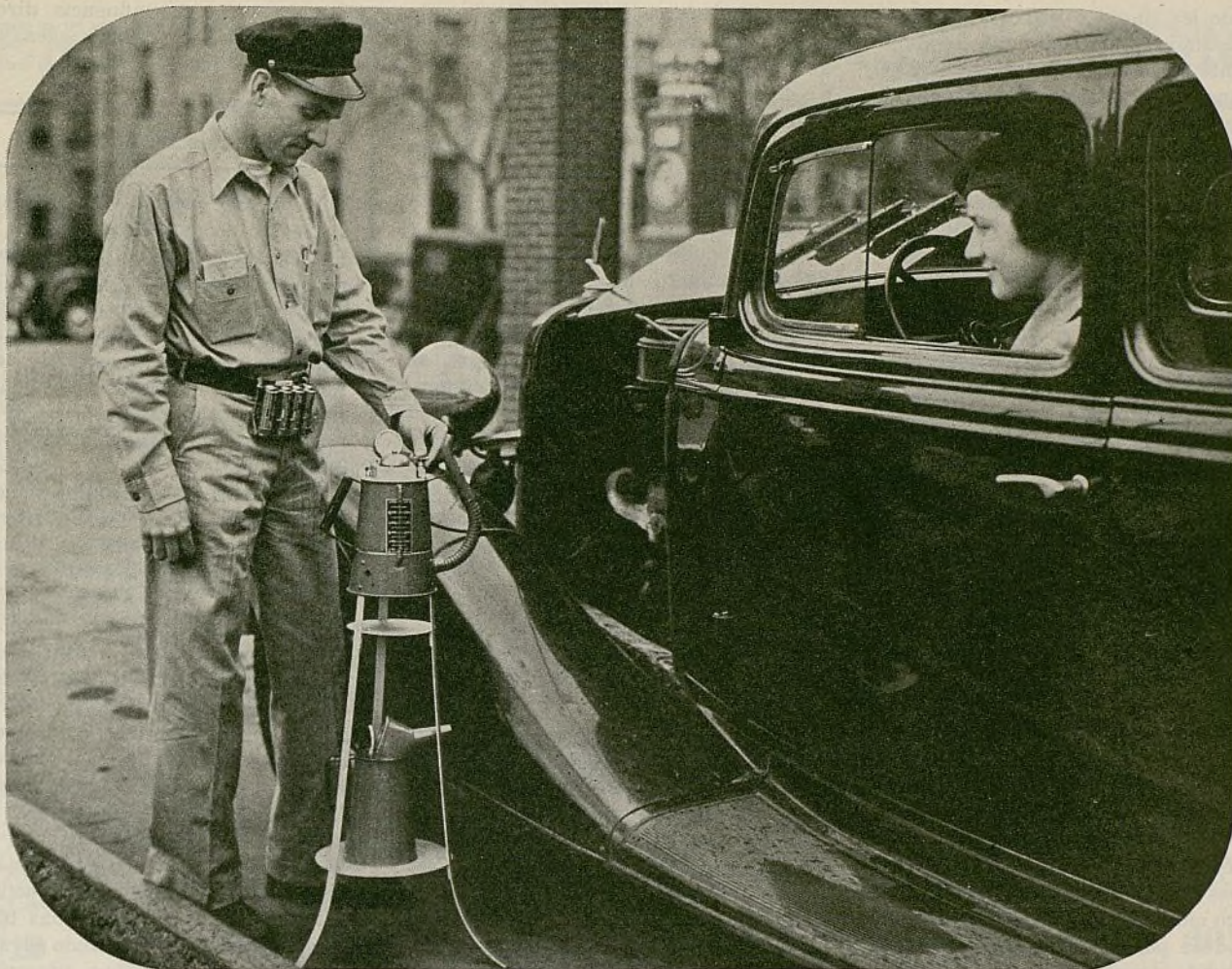
Hay ensayadores de bomba de combustible para verificar la presión y la cantidad del abastecimiento.
