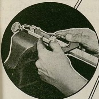
Lima AMMCO para anillo de émbolo — ajusta anillos de émbolo en la mitad del tiempo. Evita la deformación de anillos, rayadura de cilindros y recalentamiento excesivo.
