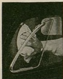
Mostramos aquí la aleta con su parte superior inclinada hacia afuera, para facilitar la limpieza.
