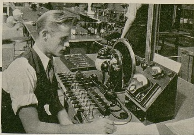
Este equipo especial prueba las unidades de ignición bajo condiciones tales como se encuentran en servicio efectivo.
