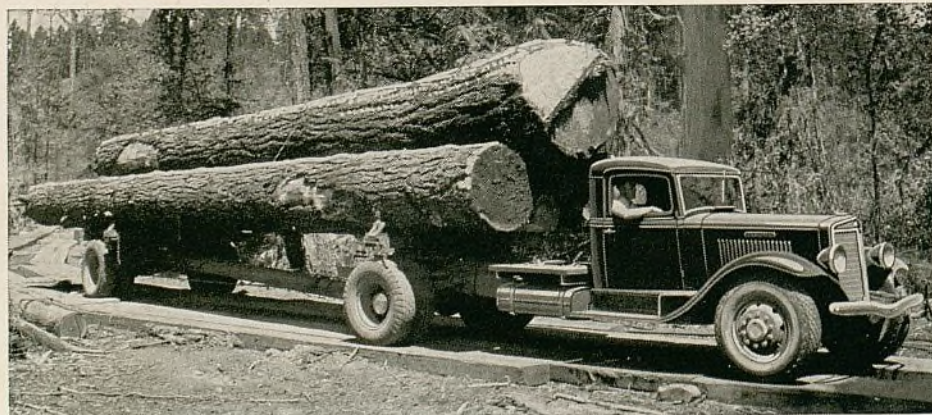
Arriba: Una combinación de camión International y vagón de remolque de dos ruedas de 6.300 kg. de capacidad, dedicada al transporte de troncos. Los camiones de seis ruedas con doble propulsión o con ejes suplementarios se emplean también mucho en esta clase de trabajo.
