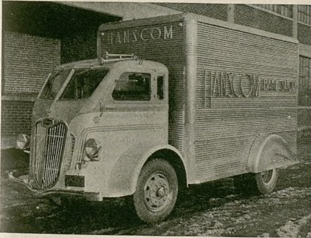
Abajo: Caja liviana de acero inoxidable construida por la E. G. Budd Mfg. Va montada sobre un chasis Autocar. El aislamiento de la caja permite que los productos de panadería que transporta se conserven calientes hasta que se repartan entre los parroquianos
