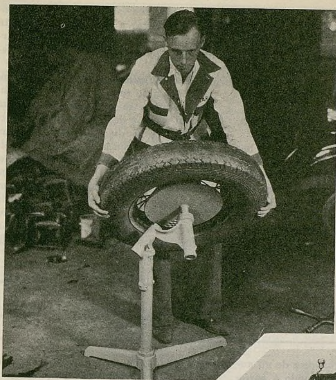
La cabeza del husillo es giratoria para facilitar el montaje de la rueda en la equilibradora Bear
