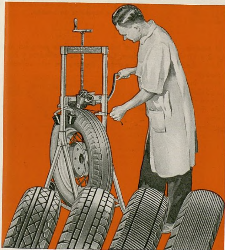
Arriba—Ensayador Bendix-Cowdrey de frenos en las cuatro ruedas—Mide exactamente la resistencia de cada rueda mediante cuatro motores eléctricos separados que dan movimiento a las ruedas mientras están enfrenadas. Registra los resultados en libras de empuje sobre camino en cada cuadrante. Se emplea en los principales países del mundo y por casi todos los fabricantes americanos de automóviles.
