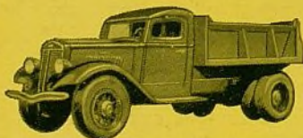
Chasis de servicio pesado con caja de vuelco.
