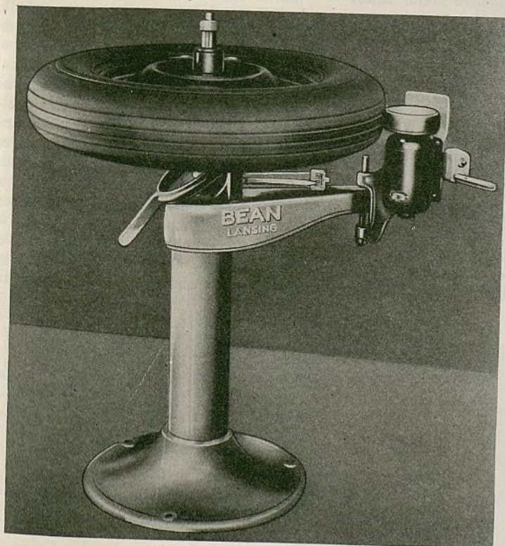
El indicador en la equilibradora dinámica Bean muestra la locación y cantidad aproximada de desequilibrio de rueda
