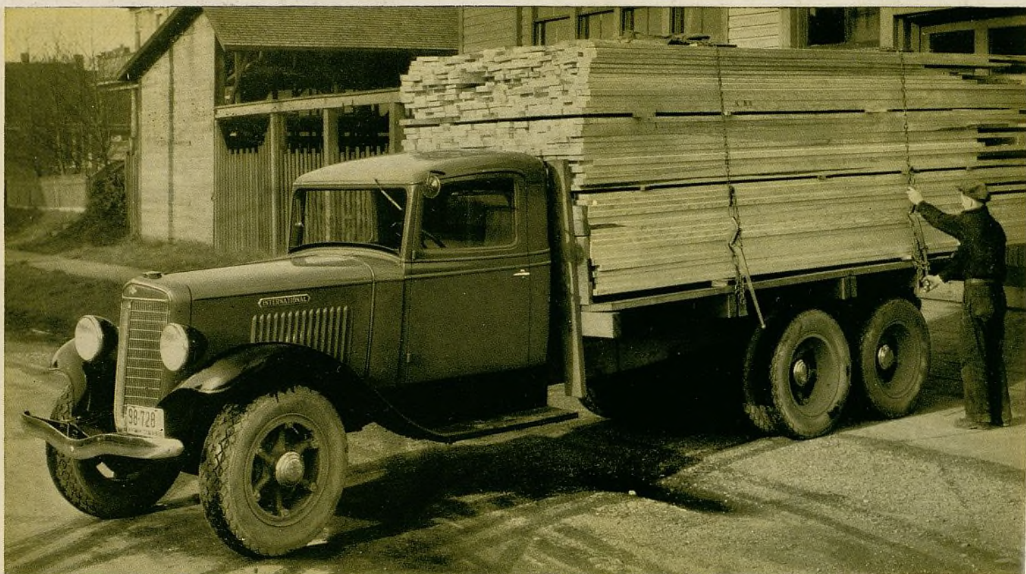
Arriba: El camión International de seis ruedas, modelo CS-35-T. Este nuevo camión tiene capacidad de 5.200 kilogramos y está provisto de eje trasero de dos velocidades, que aumenta al doble las velocidades del cambio de marcha, dando 8 velocidades hacia adelante y 8 marchas atrás.
