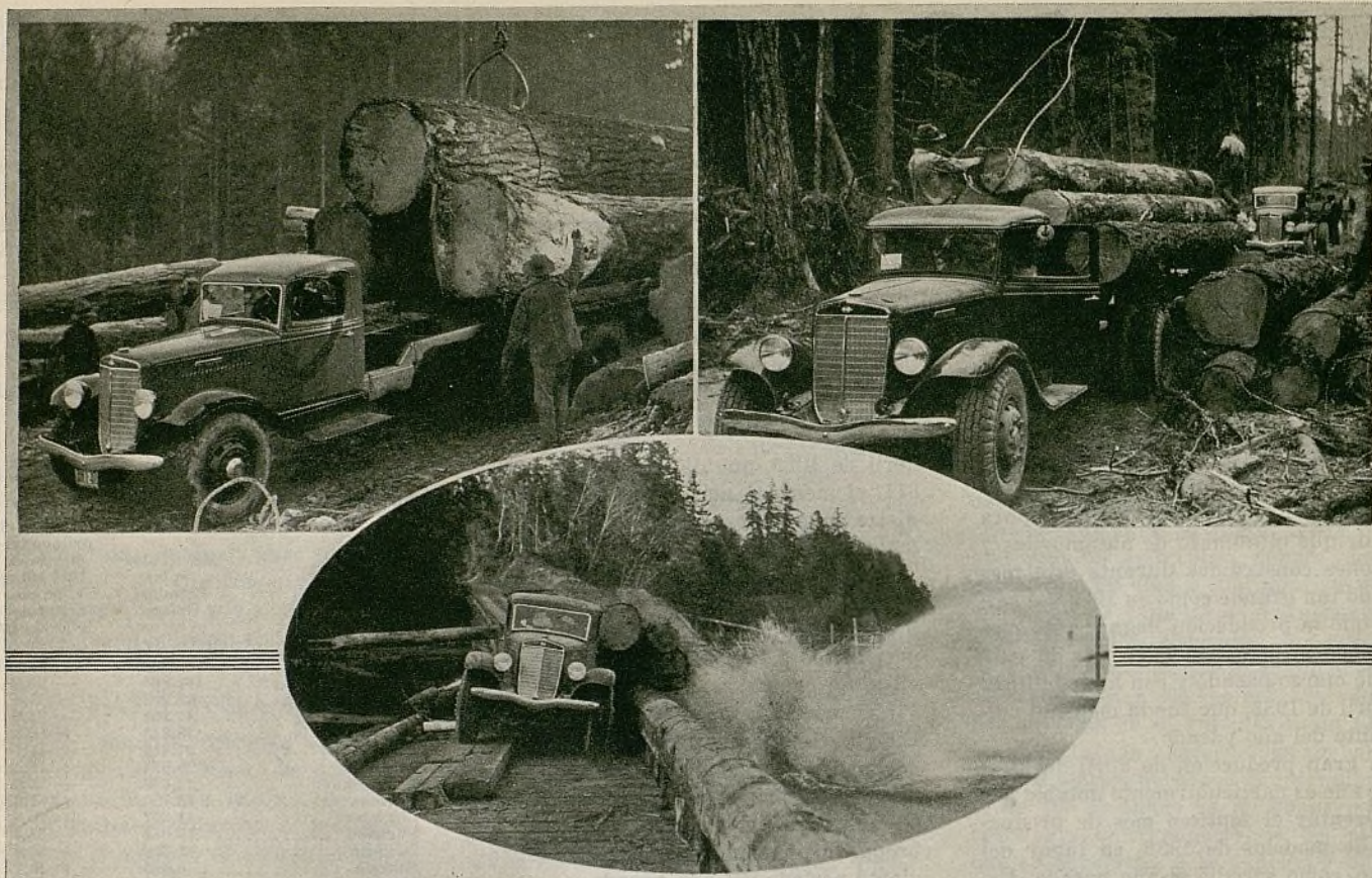
Uno de los trabajos más difíciles a que puede someterse un camión es el arrastre y transporte de troncos de árboles. En las fotografías de arriba mostramos camiones International dedicados a este difícil trabajo en la región noroeste de la costa del Pacífico de los Estados Unidos. El trabajo se hace generalmente por carreteras provisionales. Los troncos se transportan tres o cuatro millas hasta el río más cercano, se vierten aquí al agua, se atan y se dirigen a flote hasta el aserradero
