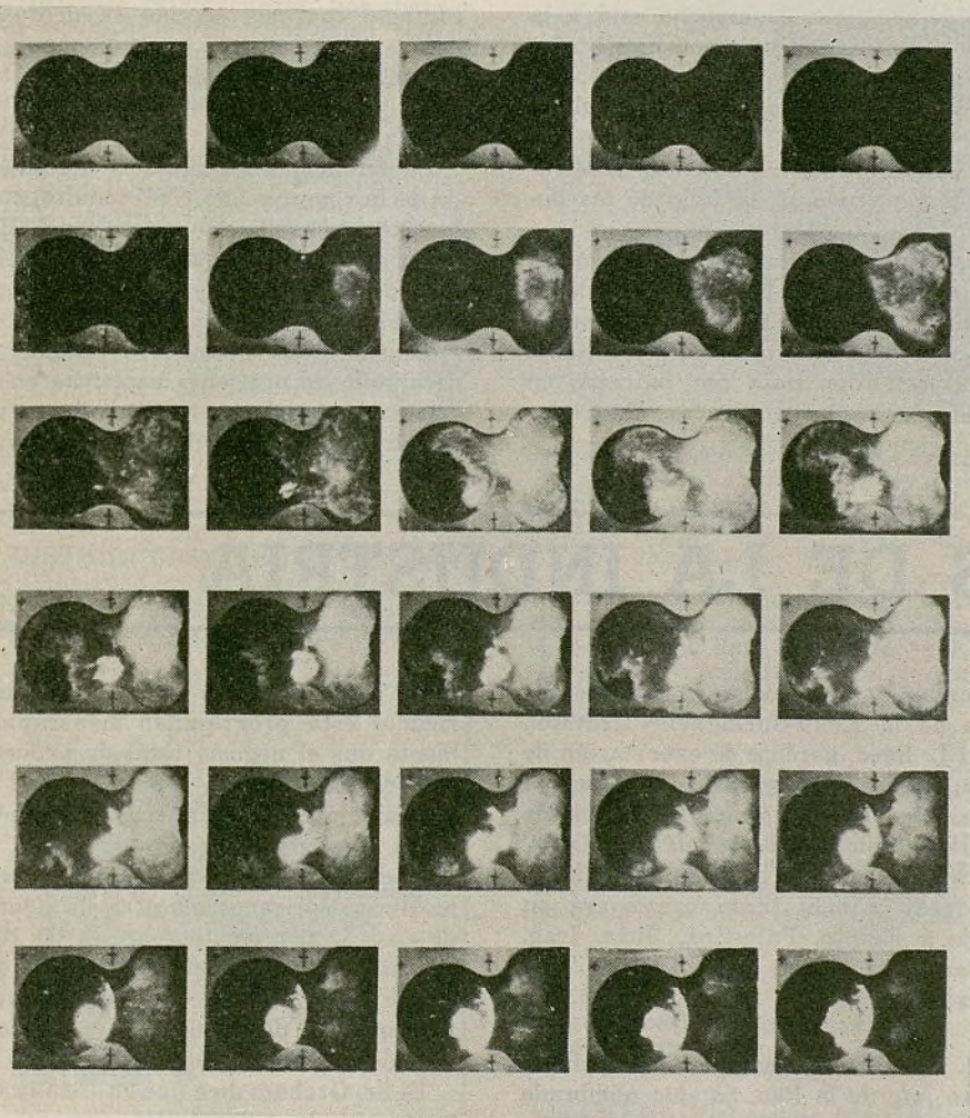
Lo que sucede en la cámara de explosión al encenderse la mezcla combustible ha sido presentado fotográficamente por los ingenieros de la General Motors mediante el empleo de una máquina fotográfica de alta velocidad y cámara de explosión provista de ventanilla de cristal especial. La serie de fotografías, empezando con la primera de arriba de la izquierda, y siguiendo de izquierda a derecha, hasta la última de abajo de la derecha, representa únicamente la explosión de la mezcla. Cada vista fué tomada en 1/5000 de segundo. La bujía se ve primero en la segunda vista de la primera hilera. La explosión empieza 1/5000 de segundo después. La llamarada se extiende gradualmente de un lado al otro de la cámara
