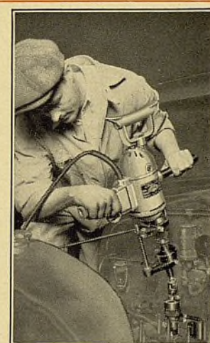
Un taladro eléctrico, usado con los neceseres No. 750 y transmisión motriz Sioux No. 747, puede perforar viejos asientos de válvula.
