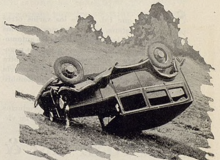
Las carrocerías de acero fabricadas por la Chrysler Motors han sido probadas echando a rodar un automóvil desde lo alto de un cerro—no sólo una sino repetidas veces—sin que la carrocería sufriera averías de importancia.
