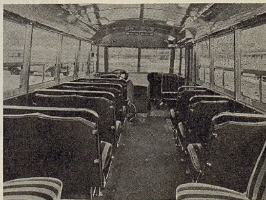
Izquierda — Una aleación liviana de aluminio reduce el peso de este ómnibus de 22 pasajeros a menos de 6.500 libras. Ha sido proyectado y construido por la Detroit Street Railway Commission y está instalado en un chasis corriente de Ford V-8. Derecha — Adentro, el conductor se sienta al lado del motor aislado. Conductor de aire, en el techo, suministran amplia ventilación. Las puertas tienen nuevos aparatos de protección y seguridad
