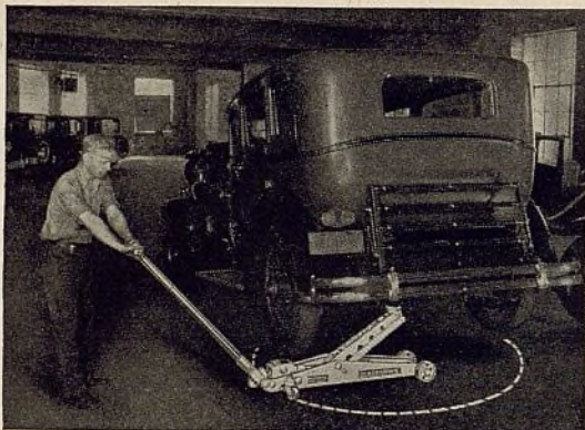
Muy fácil de girar en círculo completo para colocarlo debajo del vehículo. Se guía con suma facilidad.
