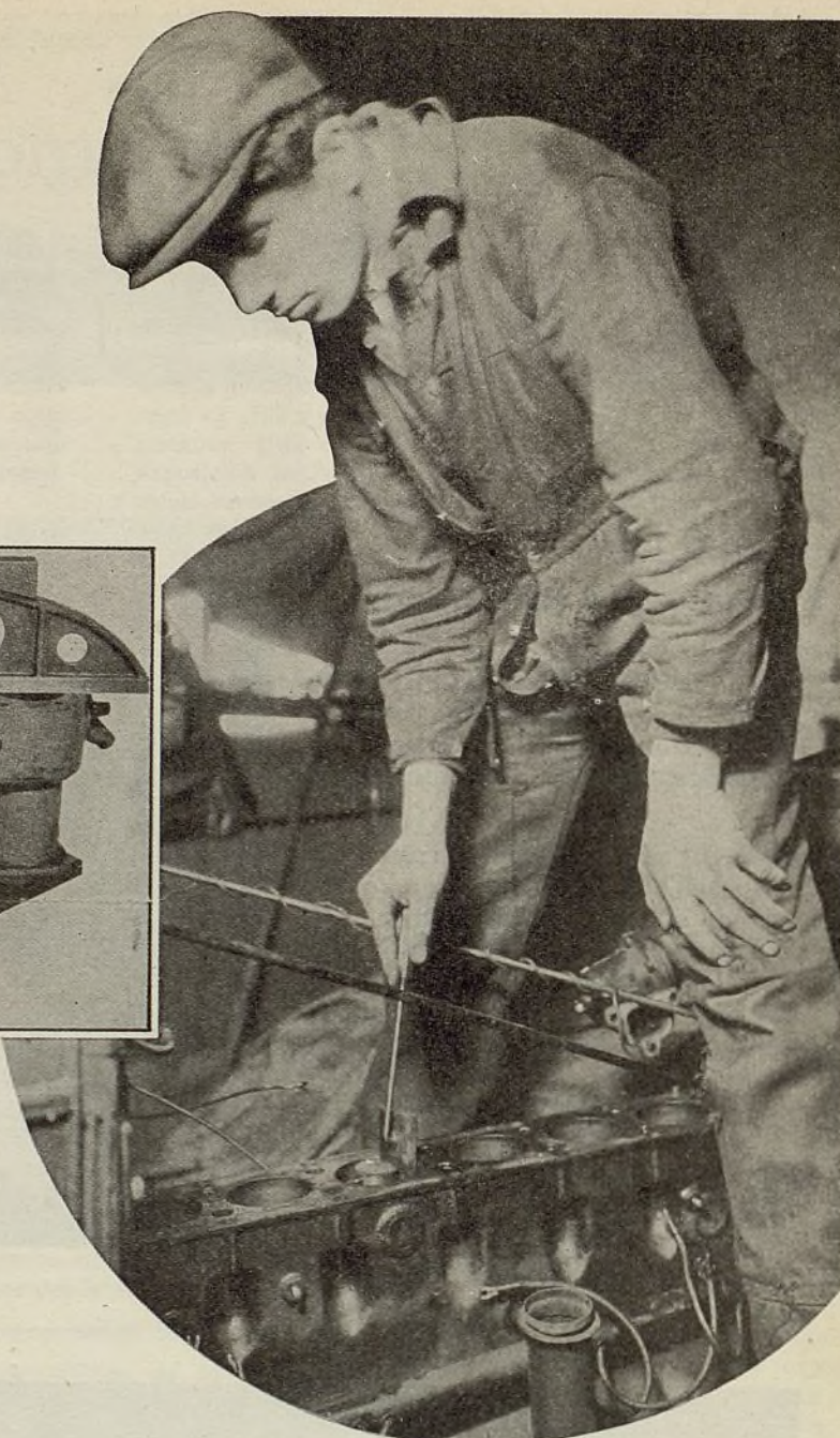
Un manómetro de cuadrante y micrómetros exteriores se emplean para determinar el desgaste de los cilindros.
