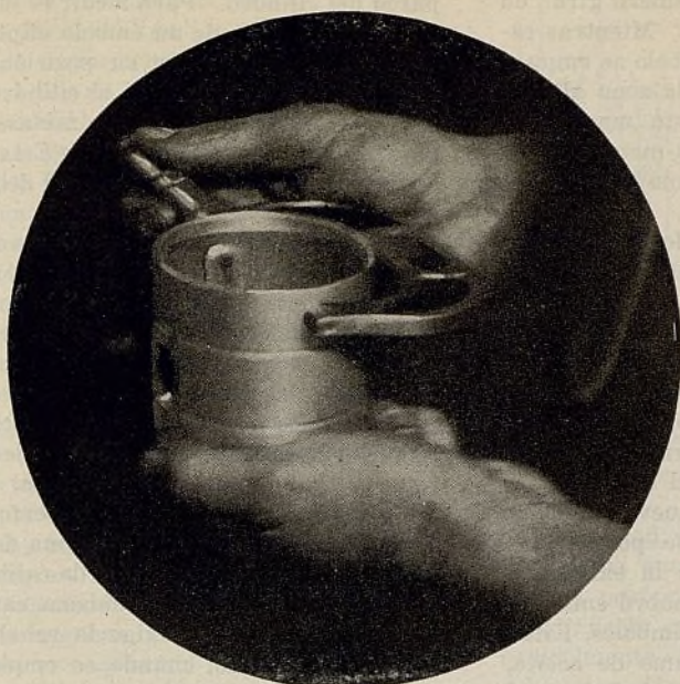
La medida del diámetro más grande del émbolo excéntrico se toma en ángulo recto con relación al pasador de émbolo
