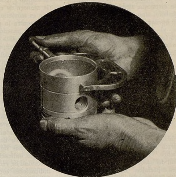
La medida del diámetro más pequeño del émbolo excéntrico se toma en sentido paralelo al pasador de émbolo
