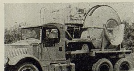
Esta carrocería con holmigonera de entrega lateral es muy útil en trabajos de construcción tales como la de caminos, alcantarillado, etc. Acelera mucho el trabajo.
