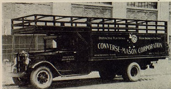
Otro ejemplo de proyección superior delantera, para agrandar la capacidad de carga de la carrocería. Sirve para objetos voluminosos, pero livianos.
