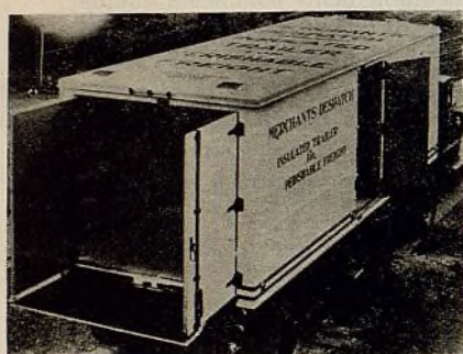
La carrocería de aluminio reduce el peso y aumenta la capacidad de carga útil. Está provista de refrigeración y también de calefacción por agua caliente, para la protección de comestibles durante el tránsito.
