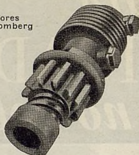
La propulsión Bendix
