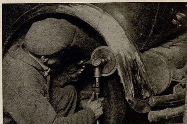
Arriba—Soldadura del reborde partido de un guardabarros. Abajo—Esmerilado mediante una lijadora mecánica, a continuación de la soldadura.
