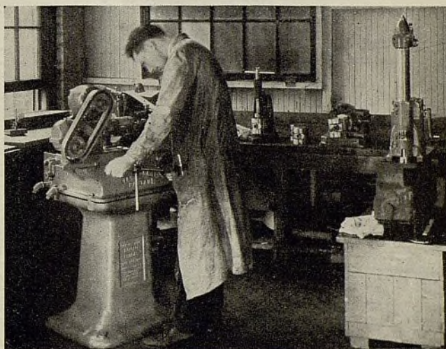
Combinación de torno y esmeriladora especial para émbolos. Esta máquina es muy útil para los talleres grandes de reparación
