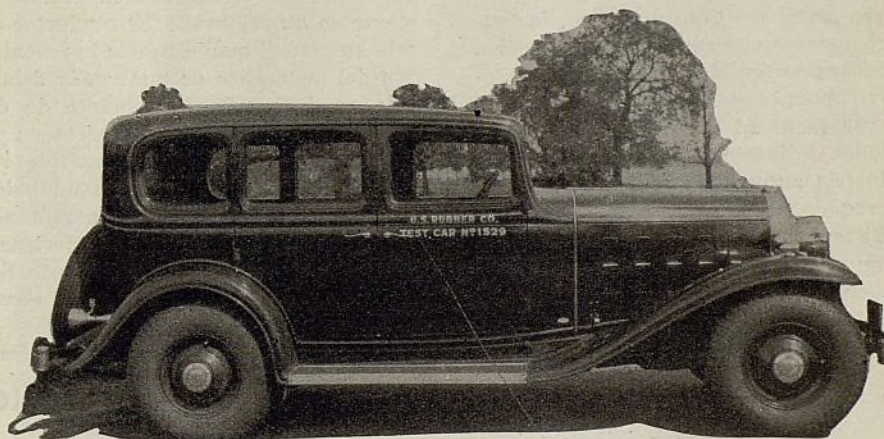
Buick, modelo 60, de 1932, provisto de superbalones de 8.25-16" en llantas metálicas de 16". El neumático normal es de 6.00-18". Muchos ingenieros creen que el tipo superbalón es demasiado grande, en lo tocante a aspecto, conducción y otras consideraciones técnicas
