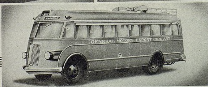
Tres modelos de los nuevos camiones y ómnibus Chevrolet de gobierno al frente, descritos en nuestro número anterior. Este surtido de camiones de servicio pesado se ofrece en distancias entre los ejes de 117½ a 155½", con motor de gasolina de 78 c. de f. o con motor diésel Hercules de 77 c. de f. El motor diésel se ofrece también con el surtido de ómnibus
