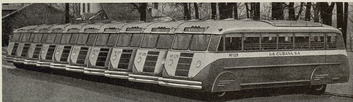
Arriba: Diez ómnibus metropolitanos de 25 pasajeros, con carrocerías enteramente metálica, recientemente enviados a Cuba, para servicio entre la Habana y Santiago de Cuba. Los chasis son de marca International . . . modelo C-35-B, con 175 pulgadas de distancia entre los ejes.
