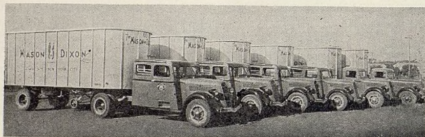
Mason-Dixon Lines, Atlanta, Ga., es dueña de esta brigada de vagones de remolque de aluminio, de tipo monocoque, que hace un viaje de 942 millas entre Atlanta y Nueva York. Cada vagón de remolque tiene 20 pies de largo, 7½ pies de ancho y 6½ pies de alto. Cada uno pesa 3.720 libras. El Sr. King, presidente de la compañía, manifiesta que ahorra $13.50 por unidad por viaje, debido al menor peso del vagón de remolque. Empleando camiones tractores Studebaker, la empresa garantiza entregas dentro de dos días entre ambas ciudades
