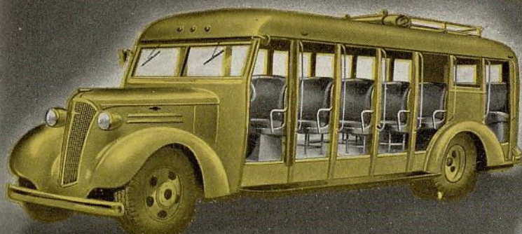
Chasis de ómnibus convencional BG-185 de 185 pulgadas entre ejes con carrocería Trelco abierta.
