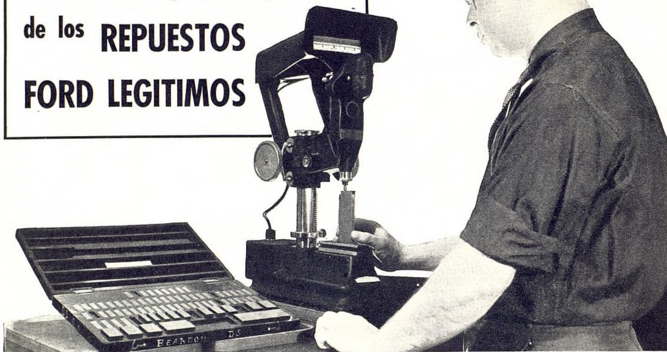
Los calibradores de inspección son ajustados con toda exactitud por medio de los Bloques Calibradores Johansson.
