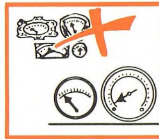
Instrumentos de Fácil Lectura (Grandes, de tipo de aeroplano)
