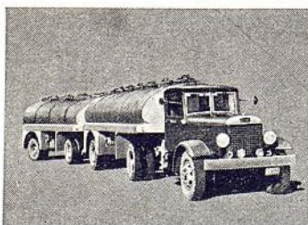
Camión Autocar-Diésel, de la Standard Oil Co. empleado en los E.U.A. para reducir el costo de transporte de gasolina. Los modelos Autocar-Diésel transportan, a alta velocidad, cargas hasta de 40 toneladas.
