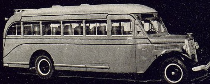
OMNIBUS URBANO O INTERURBANO DE TIPO CORRIENTE. SE OFRECE EN VARIOS CHASIS CON BASTIDOR RECTO O BAJADO
