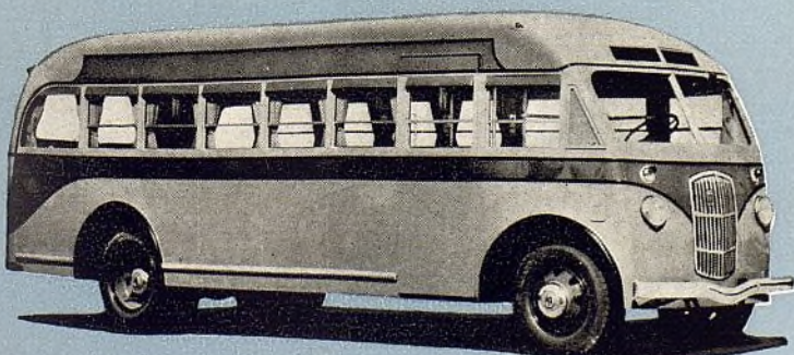
MODELO METROPOLITAN, CON PROPULSION DELANTERA, PARA SERVICIO DE OMNIBUS URBANO O INTERURBANO
