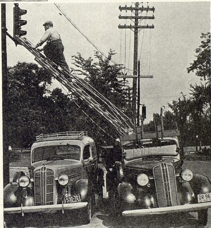
CAMION DE CONSERVACION . . . Una escalera de extensión, montada en un camión Dodge de media tonelada, se utiliza por el departamento de seguridad de la ciudad de Toledo para la conservación y reparación de los sistemas de alarmas de incendio y policía municipales. Extendida, la escalera tiene 24 pies, y plegada, 12 pies de longitud. Este tipo de escalera puede utilizarse aun cuando el camión esté al lado de un automóvil estacionado.
