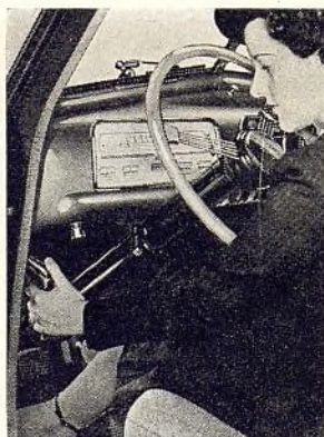
LA PALANCA DE ENFRENA-MIENTO está ahora a la izquierda, retirada de los pasajeros.
