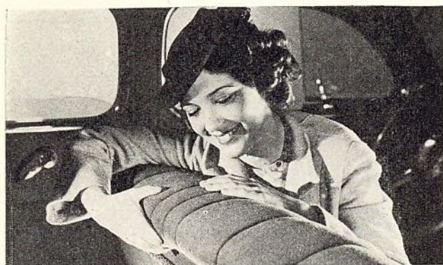
RESPALDO DEL ASIENTO DELANTERO , con gruesa almohadilla y curvo arriba, para servir de cojín en caso de choque. Los mangos de puertas y reguladores de ventanas se curvan hacia adentro.
