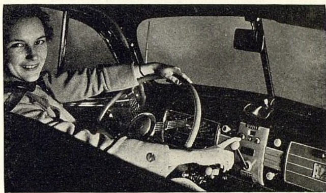
EL TABLERO DE INSTRUMENTOS de cada serie es completamente nuevo, con guarniciones de un nuevo material plástico moldeado, llamado Tenite. La palanca del cambio de marcha al vacío está al fondo del panel.
