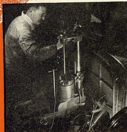
ABAJO — Cuatro uñas patentadas (soportes de extensión no giratorios) sirven de exacta guía a la fresa, en toda su carrera HASTA EL FONDO del cilindro.
