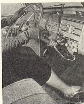
EL GOBIERNO DEL CAMBIO al vacío está debajo del panel de instrumentos, lo que despeja el compartimiento delantero.
