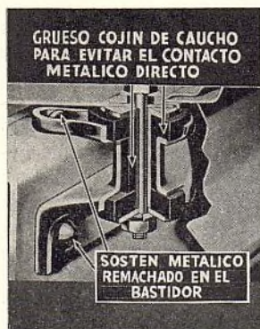
EL SOSTEN DE MONTAJE de la carrocería tiene núcleo de caucho. La carrocería queda así amortiguada en caucho flexible, independiente de la presión de sus pernos.
