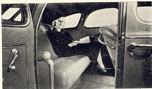
LAS CARROCERIAS son extraordinariamente espaciaosas, debido en parte a la eliminación de los estribos y empleo del eje trasero de tipo hipoidal, que baja el árbol propulsor.
