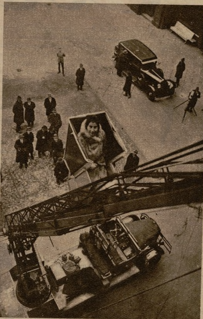
El Cuerpo de Bomberos de Berlín ha ensayado con éxito el nuevo aparato salvavidas que reproduce la fotografía. Se trata de una cesta que se desliza suavemente a lo largo de las escaleras, y donde pueden ser transportadas con toda seguridad personas ancianas, enfermos y paralíticos, cuya evacuación por otro procedimiento sería muy difícil
