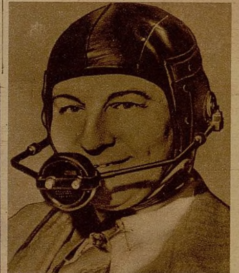
El famoso constructor de aeroplanos Mr. Sokher muestra el casco microtelefónico empleado para comunicar en pleno vuelo
