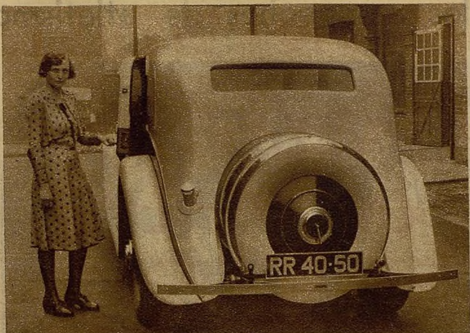
Carrocería del automóvil más caro que se exhibe en la Exposición del Olympia. Trátase de un coche salón Rolls-Royce. Aparte la forma de la carrocería, la novedad más destacada es la de que ésta cubre perfectamente las ruedas de repuesto con chapa decorada en la misma tonalidad de toda la carrocería
