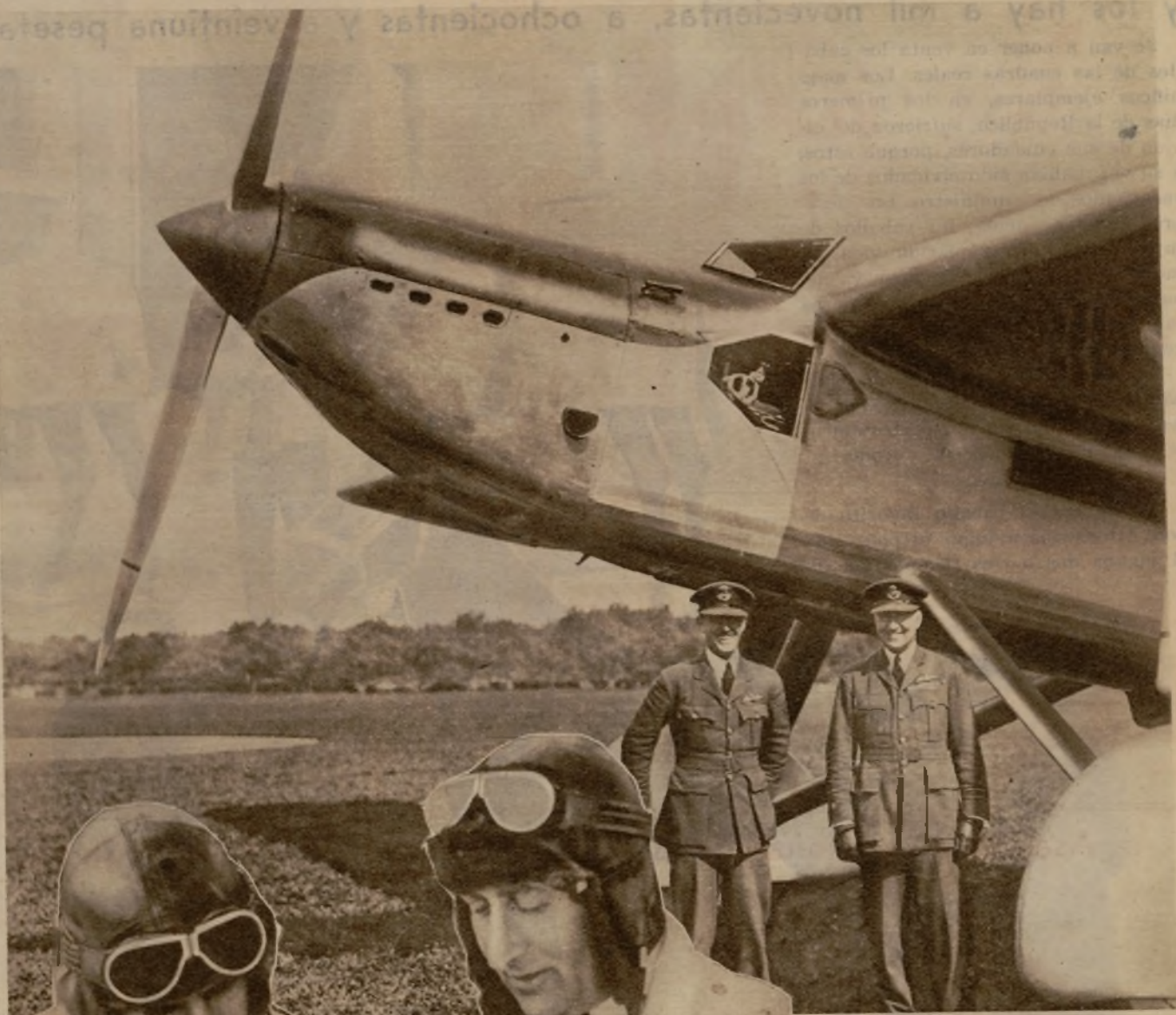
El aparato que utilizarán los audaces aviadores. Es un monoplano "Fairey", impulsado por un solo motor "Napier Lion", de 350 caballos y refrigeración por aire
