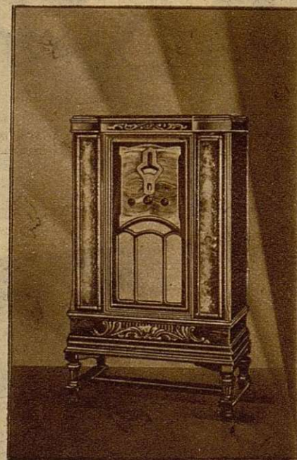
Receptor modelo Fada-74. — Superheterodino de 9 válvulas (3-F 56, 3-F 58, 2-F 247 y 1-F 280) englobando, sintonizador luminoso automático Flashograph, Silenciador de Sintonía, control automático de volumen, control de tono y filtro de ruidos, altavoz de nuevo diseño, en un mueble de líneas severas y elegantes. Se fabrica en modelo radio solo y combinado con fonógrafo (en cuyo caso se denomina 74-C), empleando este último motor y pick-up de dos velocidades, para tocar discos normales y los nuevos de larga duración que se presentarán en breve. — Fada-74, en consola: Ptas. 1650. — Fada-74 C, radio-fonógrafo: Ptas. 2190.
