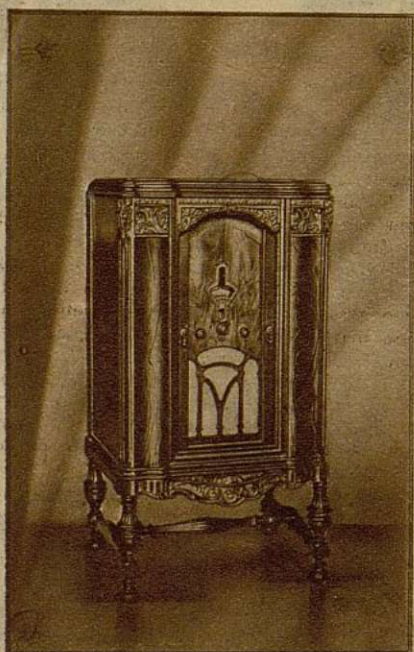
Receptor modelo Fada-75. — Superheterodino de gran lujo empleando 11 válvulas (3-F 56, 4-F 58, 1-F 57, 2-F 247 y 1-F 280) con eliminador automático de ruidos, sintonizador luminoso automático (Flashograph), control automático de volumen, control de tono y altavoz perfeccionado de nuevo diseño. Se fabrica en dos modelos: radio solo y radio-fonógrafo (78-C) estando este último equipado con motor gigante y pick-up especial preparados para tocar indistintamente discos corrientes de 78 r.p.m. y los nuevos de larga duración que giran a 33 r.p.m. — Fada-75, en consola: Ptas. 2225. — Fada-75 C, radio-fonógrafo: Ptas. 2850.
