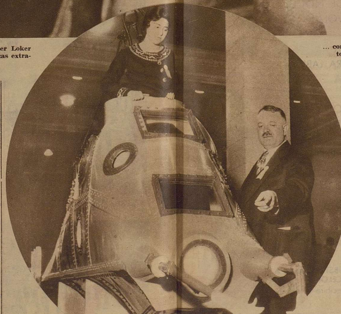
He aquí el monstruo soberano que se ha ideado para conquistar las mayores profundidades: una fortaleza sumergible, desde cuyo amplio interior operan los buzos que quedan dentro.
