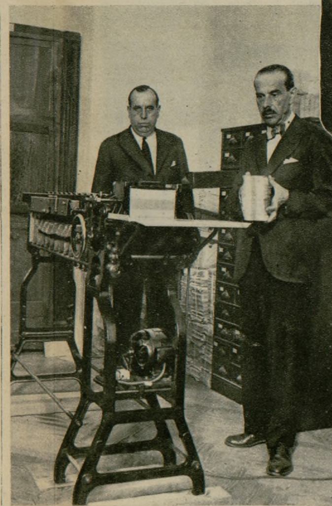
Máquina que clasifica automáticamente los miles de fichas que los funcionarios del Cuerpo estadístico utilizan para sus publicaciones
