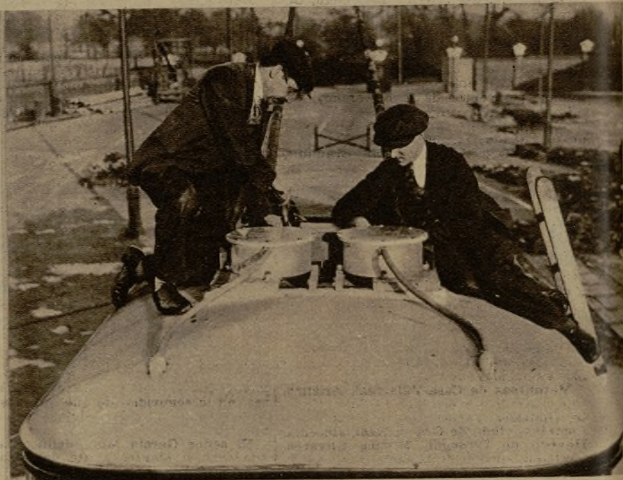
Un nuevo procedimiento para eliminar los ruidos que tanto molestan a los radioescuchas. Se trata de unos aparatos especiales, que se colocan en los techos de los tranvías y autobuses y amortiguan el ruido de estos vehículos
